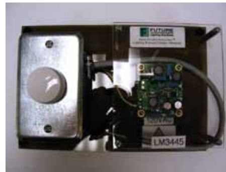
圖 15. 具有 Triac 調光器的 National LM3445 AC-DC 驅動器
